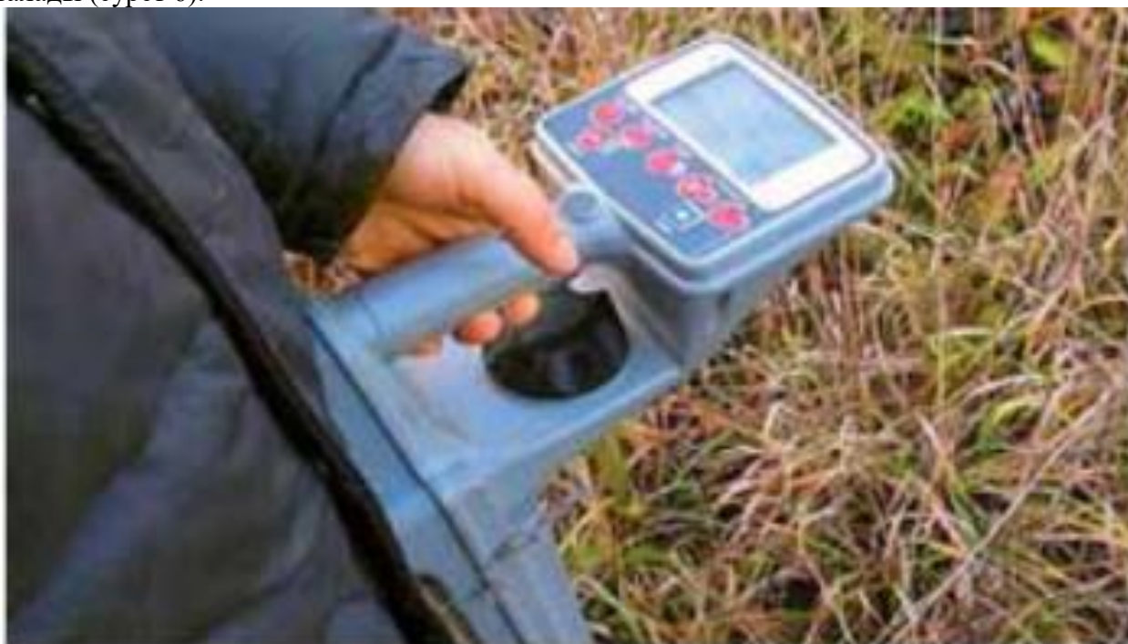
Сурет 6. Radiodetection трасса детекторының көмегімен жер асты құбырының коррозиялық және механикалық зақымдану орнын анықтау
